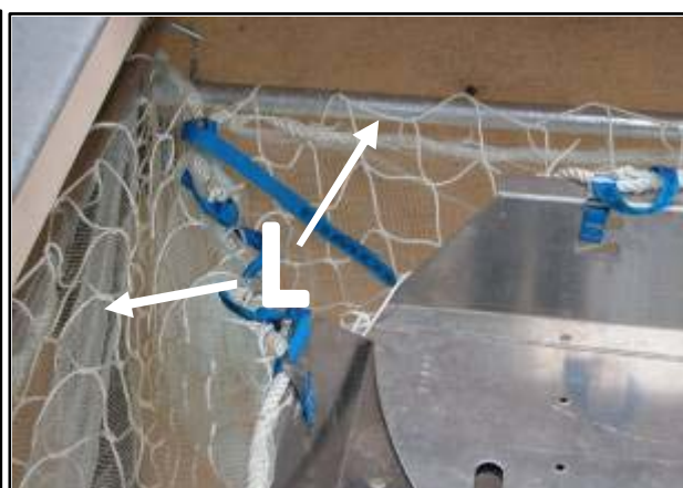
L Lisses passées maille à maille dans le filet, pour sécuriser un angle
